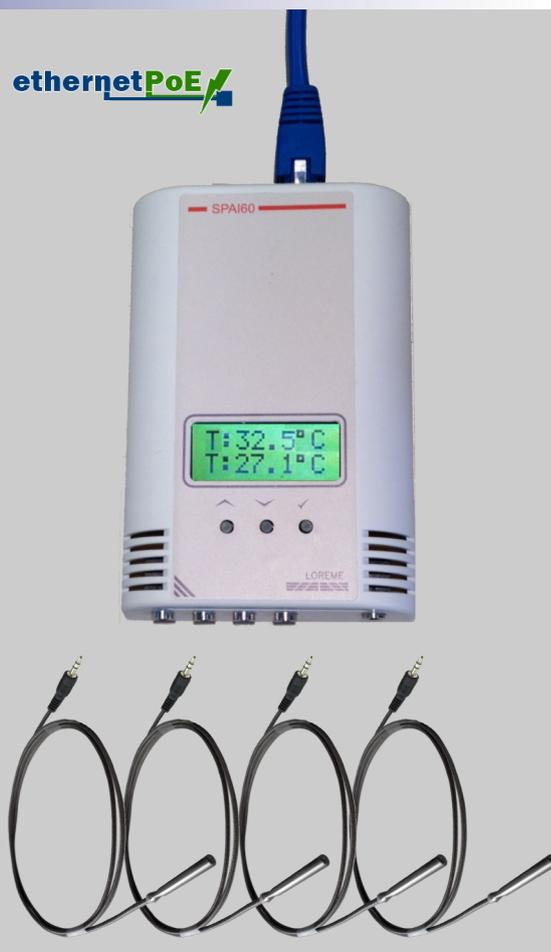
La SPAi60 est un thermomètre multi voies destinée aux applications de contrôle et traçabilité de salles à atmosphère contrôlée. Cette sonde permet le rapatriement des mesures via le protocole Modbus/TCP ou SNMP , l'envoi d'alarme par Mail et l'enregistrement autonome de fichier Excel.
